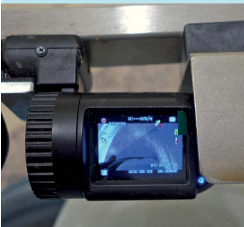
Direkt im Blickfeld des Bedieners: das Display der durch einen Edelstahlrahmen geschützten Kamera.
