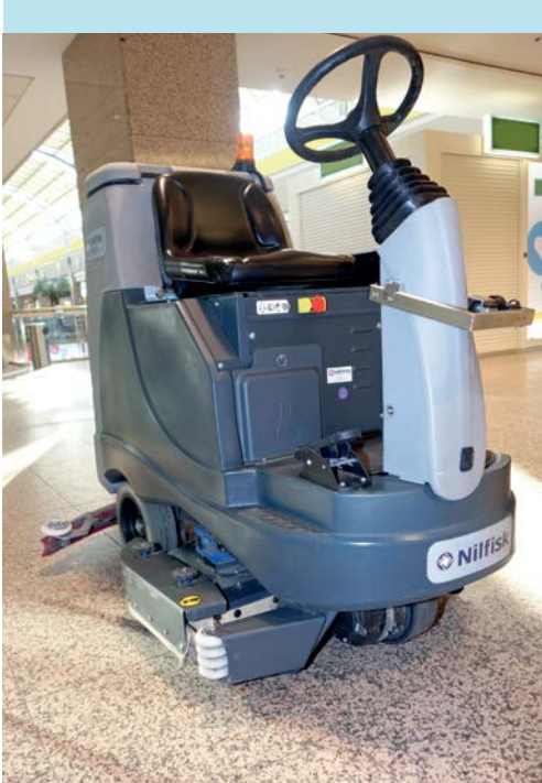
Die Nilfisk BR 855 eco mit der durch einen Stahlrahmen geschützten „Dashcam“ (vorne) und den weißen Abweissrollen (unten).
